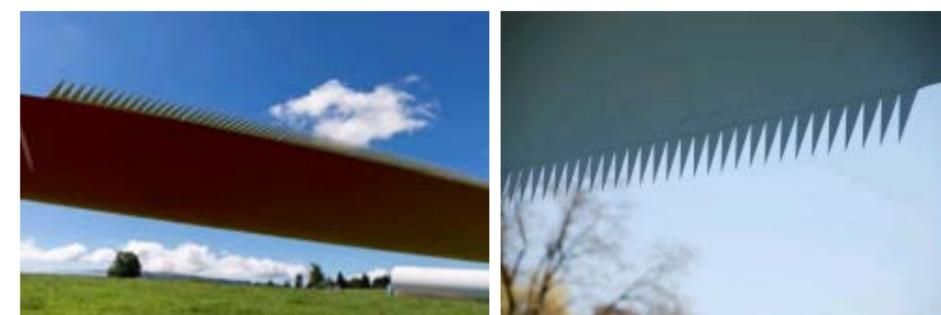
Photo 139 : Pale dotée d'un système STE (peigne / dentelure)
